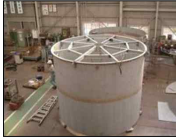
Bottom Ash Silo
