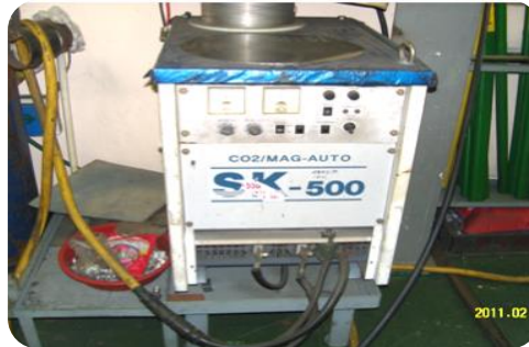
설비명 : CO2 용접기 3대 제작사 : CHEON HO
