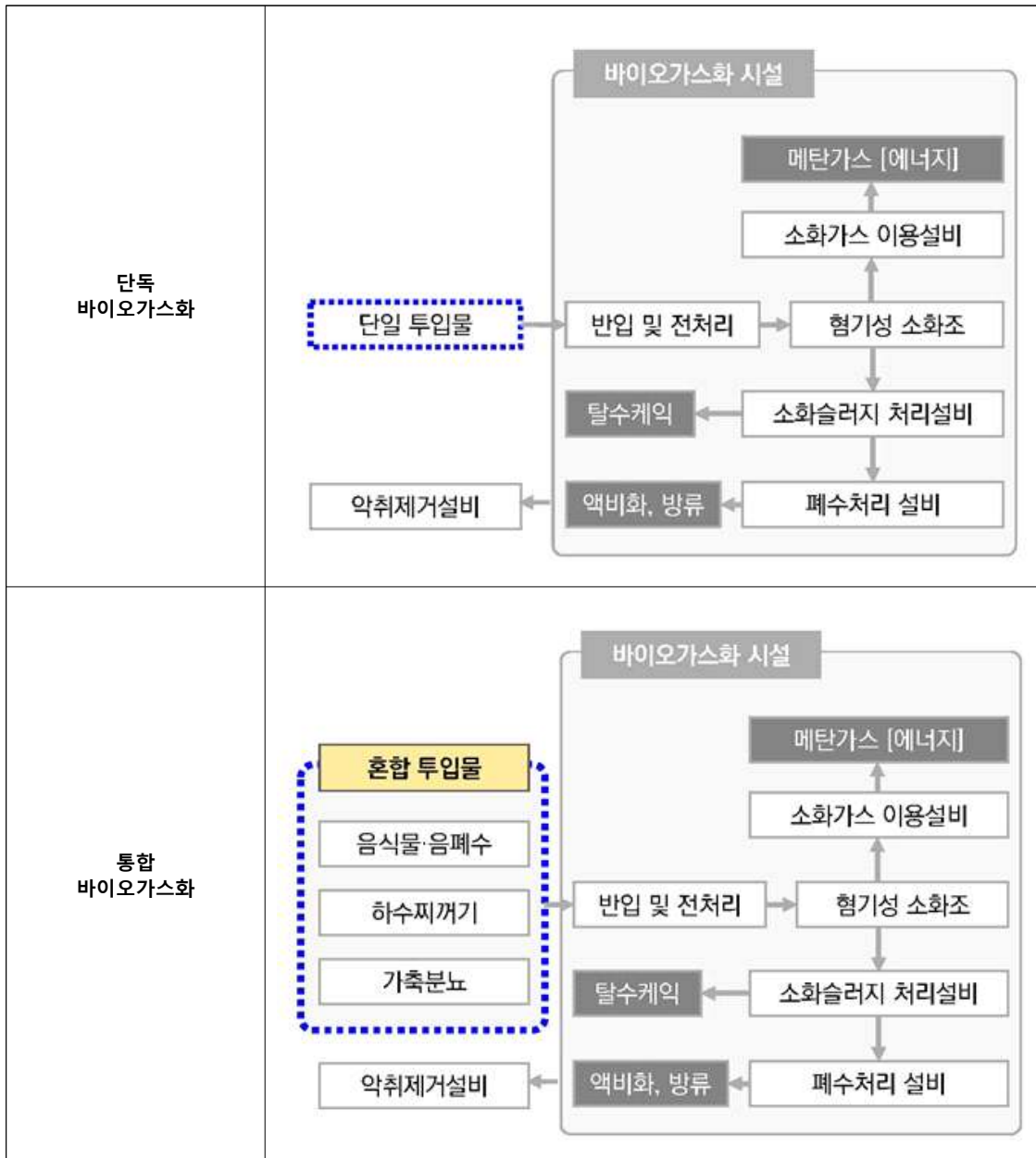
<그림 5-4> 단독 및 통합 바이오가스화 공정 원리
